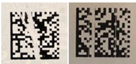
Нарушение целостности КМ*
